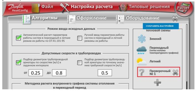
При расчете БТП будет дополнительно проверен на данные режимы. Для добавления пользовательского режима достаточно нажать на значок «Плюс». При этом будет добавлен новый проверочный режим. Пользователь может добавить до трех проверочных режимов. Для удаления Проверочного расчета необходимо нажать на крестик.
